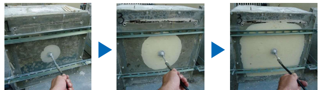
背面注入における止水剤分散性確認試験
