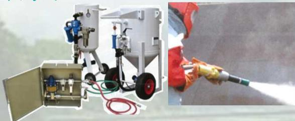
微量の高圧水を供給することにより、ブラスト作業時の粉塵を低減します。
