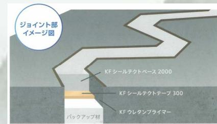
独自のウレタン合成技術によりゴム弾性を有する塗膜を形成する塗料による遊間防水工法。施工形状を選ばず高い防水機能を保持します。
