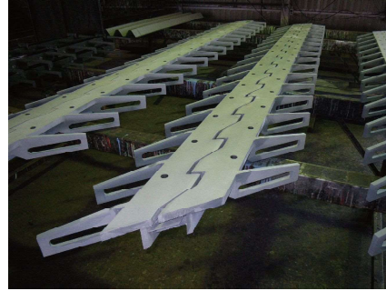
橋梁伸縮装置
