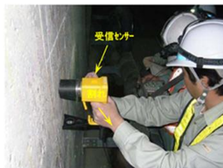
【インパクト法によるグROUT調査(せん断鋼棒)】
