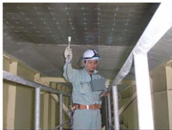
【自然電位法による鉄筋腐食調査】
