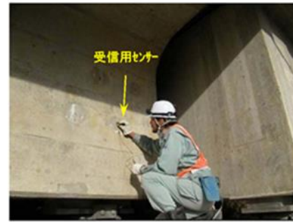
【衝撃弾性波法によるグROUT調査(横桁横締め)】
