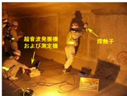
【広帯域超音波法によるグROUT調査(せん断鋼棒)】
