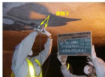
【広帯域超音波法によるグROUT調査(せん断鋼棒)】
