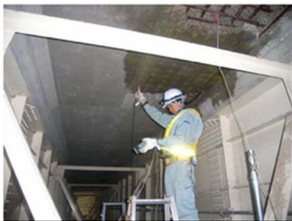
【自然電位法による鉄筋腐食調査】
