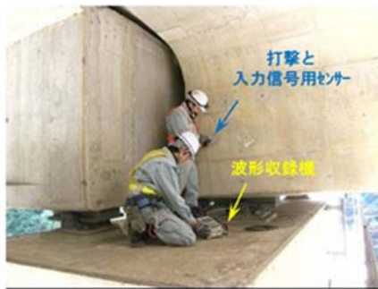
【衝撃弾性波法によるグROUT調査(横桁横締め)】
