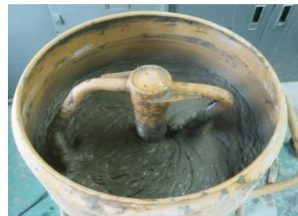
図-4 パン形強制練混ぜミキサと練混ぜ後の状況
