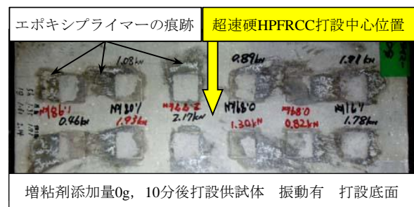
写真-2 付着試験後の供試体
