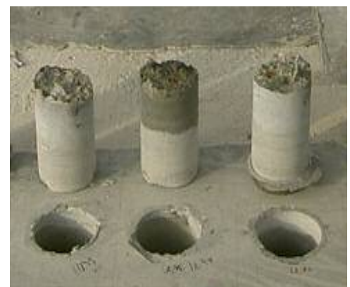
写真-11 充填後の付着試験状況
